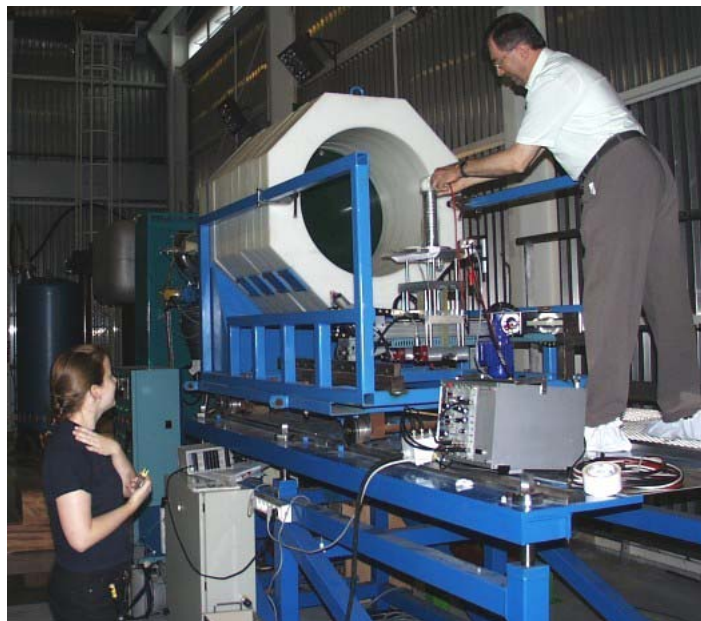
Bild 1: Neutronen-Referenzfeld CANEL/T400 des IRSN, Frankreich. Hinten links und Bildmitte: der 400 kV SAMES Beschleuniger und die CANEL Moderatoranordnung. Im Vordergrund: PTB-Mitarbeiter bei der Justierung einer Kugel aus dem Bonnerkugel-Spektrometer NEMUS der PTB.
