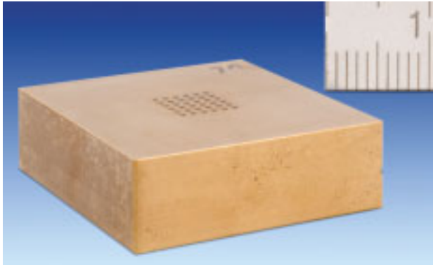
Kugelplatte mit 6 x 6 Edelstahl-Kugeln, Radius 0,25 mm, Abstand 1,3 mm, Kugeloberfläche rau, in kegelförmige Vertiefungen eingeklebt
