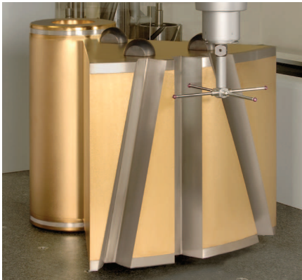
Messung des Normal auf einem KMG
