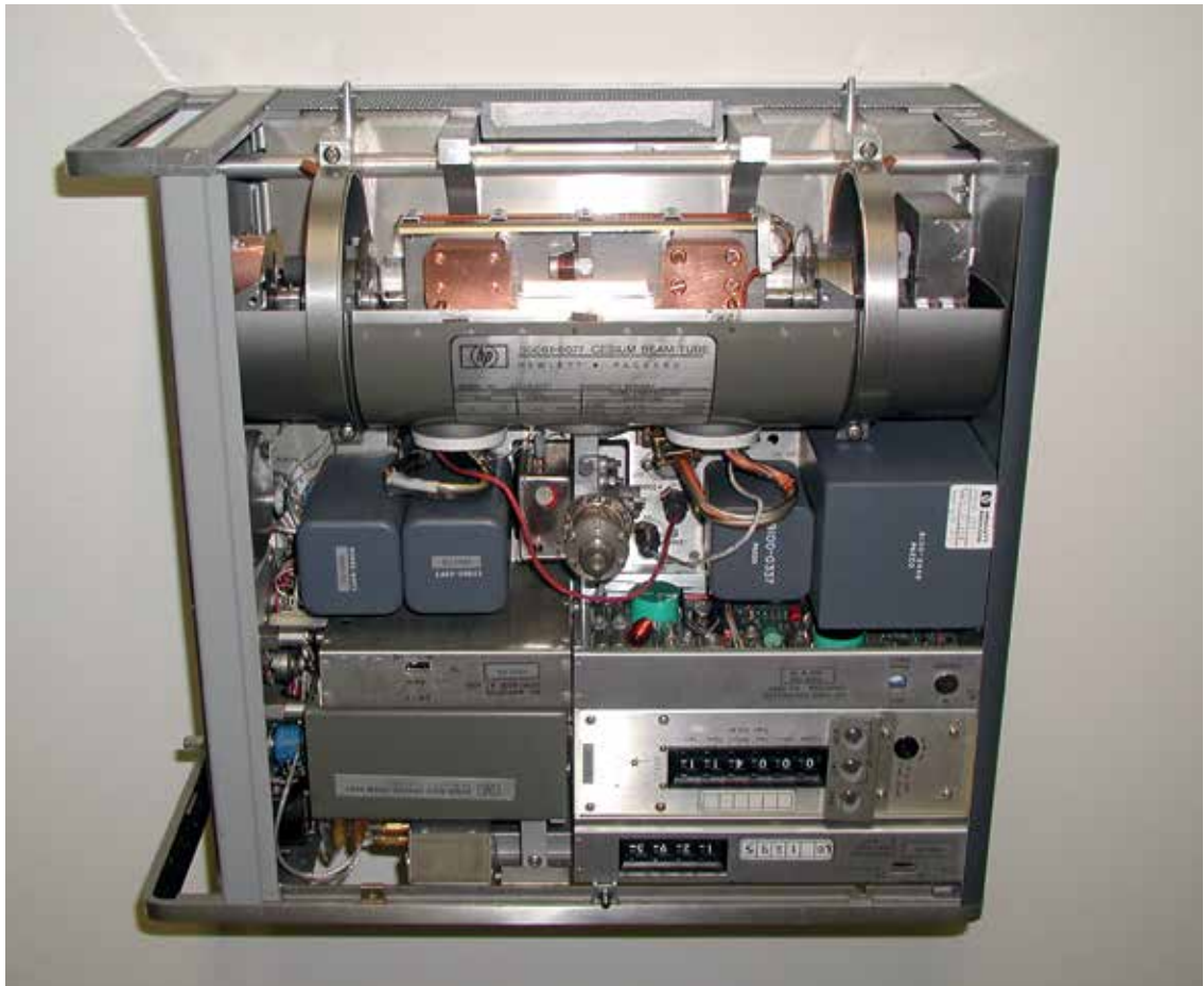
Bild 2: Kommerzielle Atom- uhr vom Typ 5061A aus dem Jahr 1996. Oben sieht man das aufgeschnittene Strahlrohr mit dem Caesiumofen links und dem Detektor rechts. Die beiden Ablenkmagnete sind durch die Hal- terung verdeckt, der Ramsey-Resonator aus Kupfer ist gut zu erkennen.
