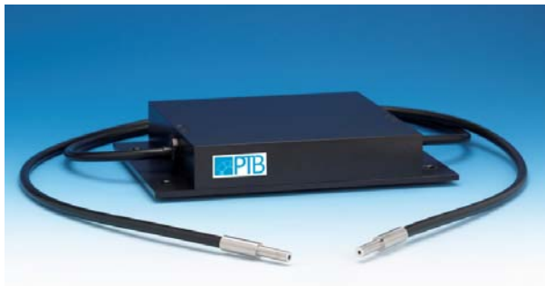
Abb. 4 Foto des Puls-zu-cw Konverters.
