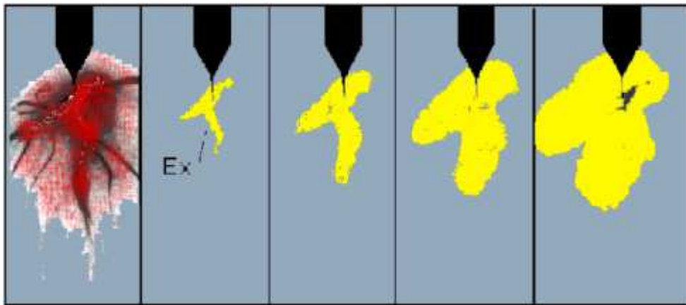
Abb. 1 Zündung eines H 2 /Luft Gemischs durch eine Vor-/Teilentladung.
