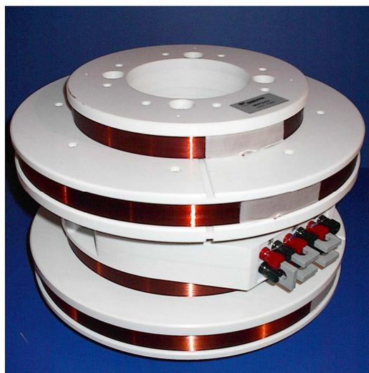
**Fig. 3** Bild eines Prototypen des kompensierten Spulensystems mit 1152 Windungen für jede der sechs Einzerspulen. Alle Anschlüsse der sechs Einzerspulen sind an dem Terminal in der Mitte des Spulensystems herausgeführt.
