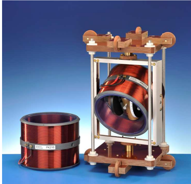
Fig. 2 Abbildung der beiden schwenkbaren Testspulen PK215 (hier rechts abgebildet mit dem Gestell zum Verfahren in den Röhren des SENSYS-Testgeländes) und PK216 (links, ohne Verfahrgestell abgebildet) zur Simulation der Streufelder von Bombenblindgängern.
