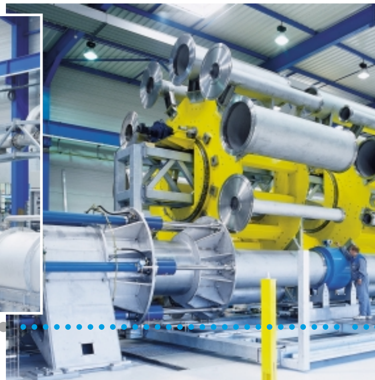
Kernstück der Anlage FCP 7.2 ist der Revolver-Adapter.
