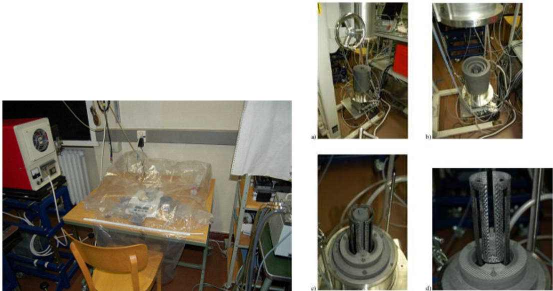
Abbildung 1: Herstellung der MC-Fixpunkte im Ofen der PTB. Links: Kunststoff-Glovebox zum Mischen und Füllen der Tiegel mit der eutektischen Metall-Kohlenstoff-Mischung. Rechts: a) Isolationskörper des Ofens, b) Blick in den Isolationskörper mit Heizer, c) Heizer und Schutzrohr, d) Heizer ohne Schutzrohr mit Tiegel für die eutektischen Metall-Kohlenstoff-Fixpunkte
