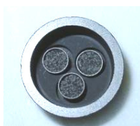
Abbildung 2: Drei präparierte Fixpunktziegel in einem Graphithalter vor dem Einschmelzen
