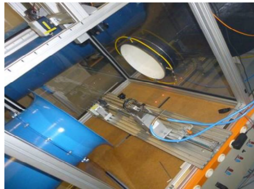
Abb. 1: Staurohr, TESTO SE Co. KGaA, Typ: 0635 2345, Länge 700 mm, Ø 7mm Einbau an der Prüflingsposition im Windkanal der Firma Höntzsch GmbH
