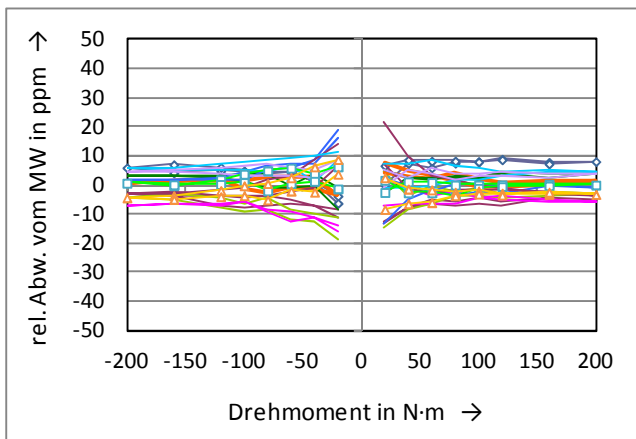
Bild 1: Messung PTB07 – Beispiel für die qualitative Bewertung eines Messergebnisses des TT1 im Pilotlabor: Relative Abweichungen der Ergebnisse der drei Messreihen, bezogen auf deren gemeinsamen Mittelwert, (Einbaustellungen: 1 – Raute, 2 – Quadrat, 3 – Dreieck, gefüllte Symbole: Aufwärtsreihen, leere Symbole: Abwärtsreihen)
