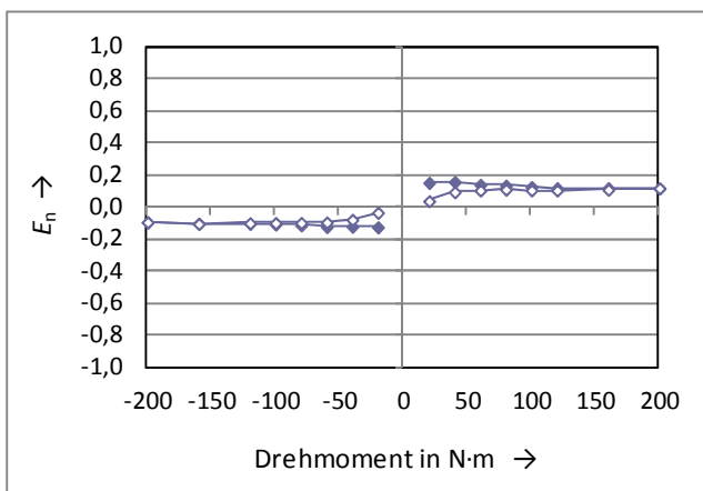
Bild 75: Berechnete E_n -Faktoren für das Messergebnis des TT1-Aufnehmers (volles Symbol – steigendes Drehmoment, leeres Symbol – fallendes Drehmoment)
