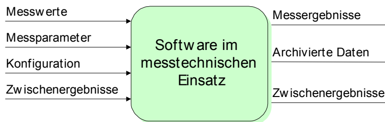
Abbildung 3: Software als Prüfmittel (Quelle: PTB)
