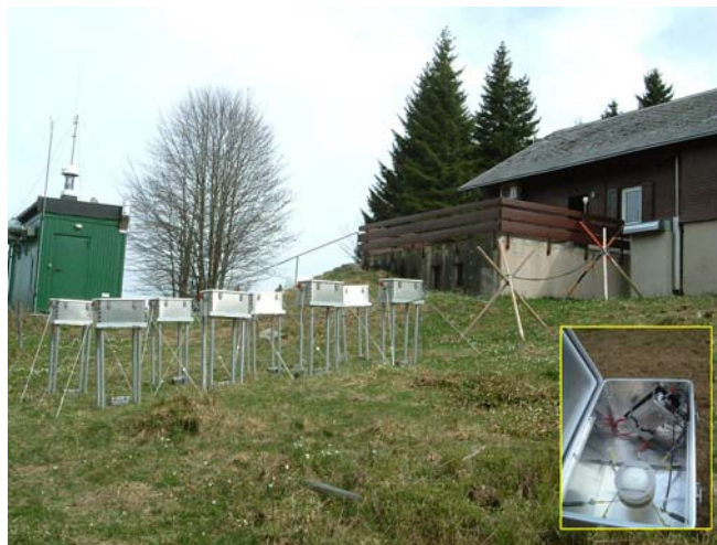
Abbildung 1 b: SIL : BfS (Bundesamt für Strahlenschutz) Messstation für atmosphärische Radioaktivität auf dem Schauinsland
