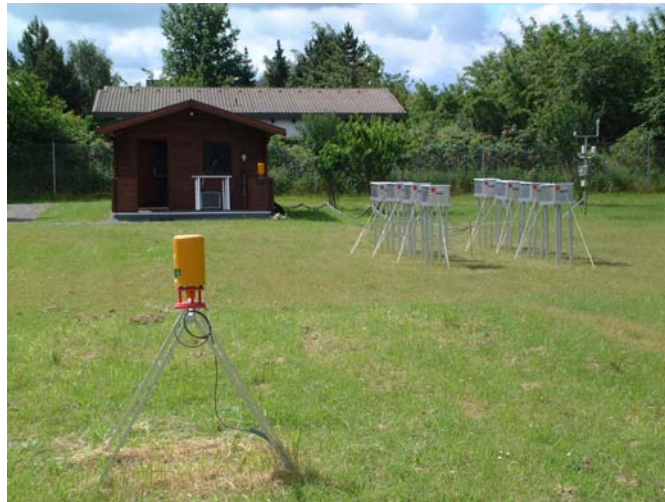
Abbildung 1 a: : Referenzmessplatz für Umgebungsstrahlung
