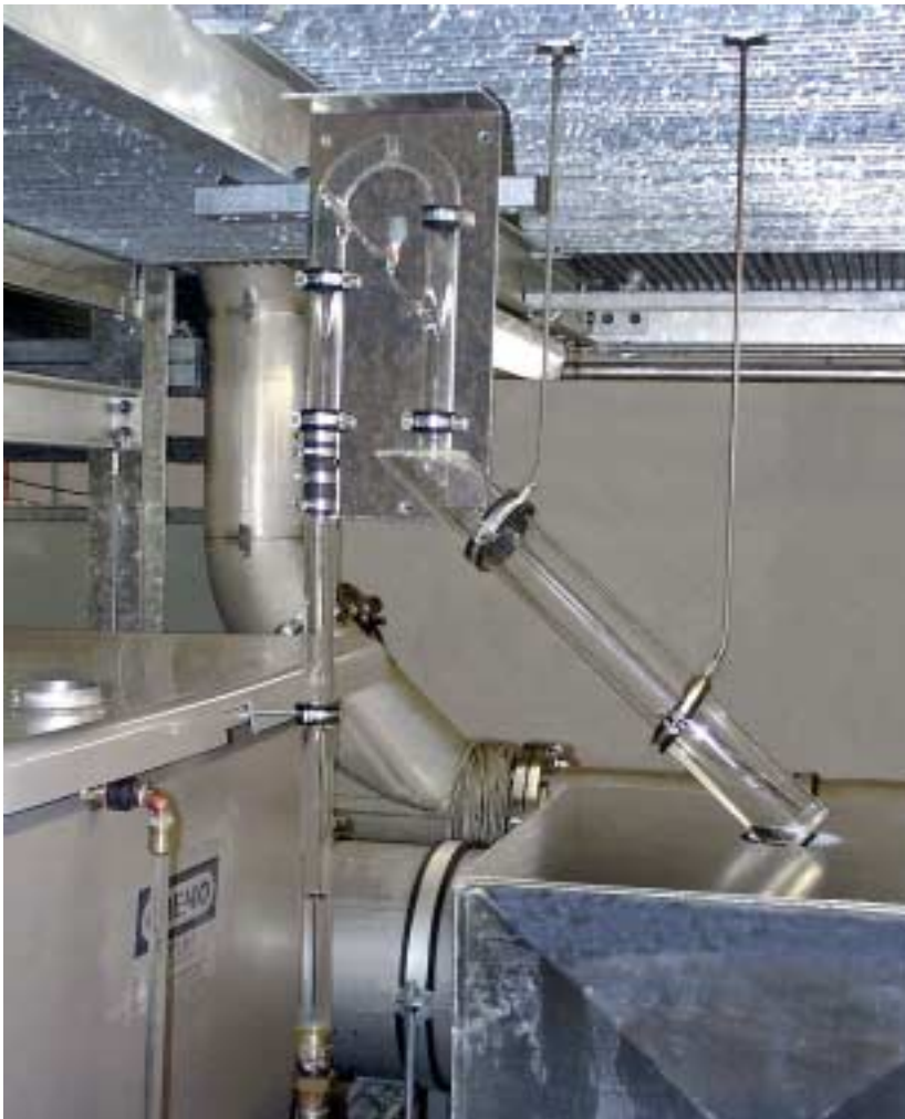
Bild 9: Teilausschnitt der Messanlage für die gravimetrische Bestimmung des Messvolumens; v. li. n. re.: 1500 l-Tank, U-Rohr mit Bypass, Wägebekälter
