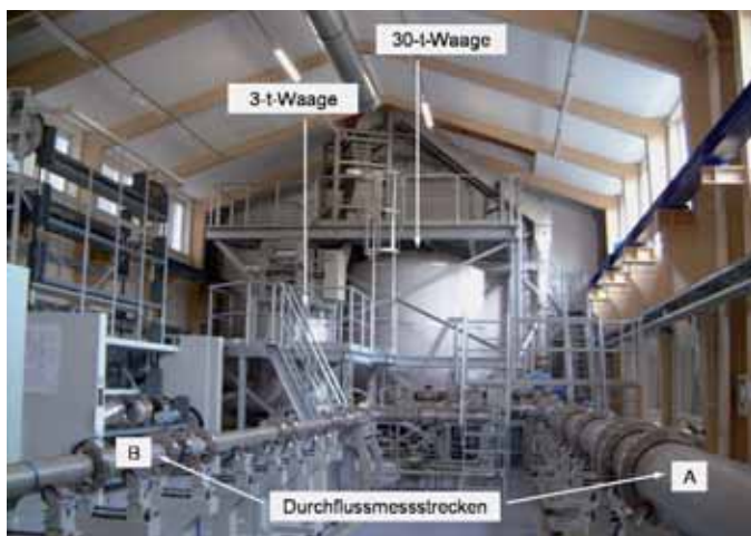
Abb. 2: Blick in die Messhalle des Hydrodynamischen Prüffeldes der PTB (im Hintergrund sind das 3-t- bzw. das 30-t-Wägesystem zu erkennen)
