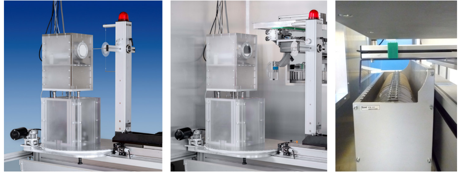
Die neu entwickelte Messkammer der PTB mit Quellenhalterung und Strahlungsfilter davor (links); ein Absorber auf dem Weg vor die Kammer (Mitte); Absorbermagazin (rechts)
